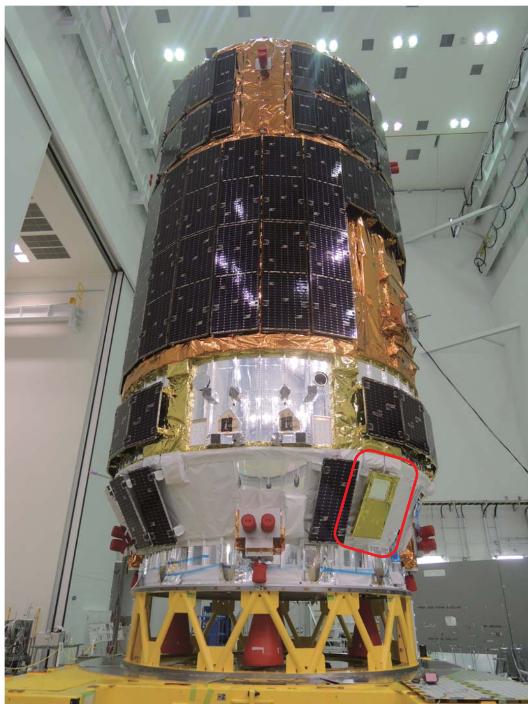
「こうのとり」に搭載された ATOTIE-mini (射場) ©JAXA
