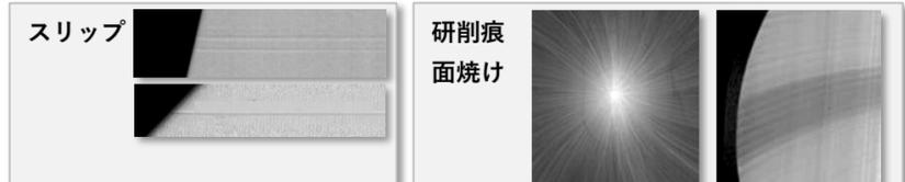
・高感度でスリップを映し出します。 **研削痕** 砥石の状態によるBG痕の不良状態を定量的に監視します。本数,長さ,長さ合計,発生位置など出力可。
